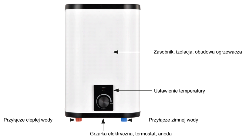
Rysunek nr 2 Budowa ogrzewacza pionowego
