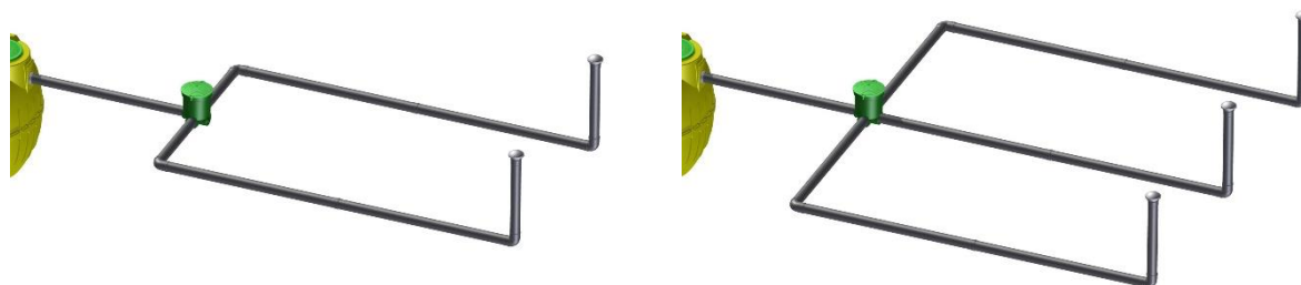
Rysunek 9: Rozkład drenaży rozsączających dla oczyszczalni BioClean 2500 (rysunek po lewej) oraz BioClean 3500 (rysunek po prawej).
