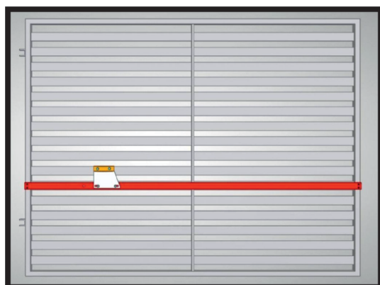
Widok poprawnie skręconego mocowania od strony posesji
