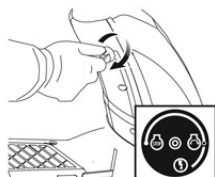
Obrócić kluczyk zapłonu (35) do położenia "START" ① do momentu uruchomienia silnika
