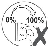
**IMPORTANT** Ne pas utiliser avec un variateur d'intensité lumineuse.
